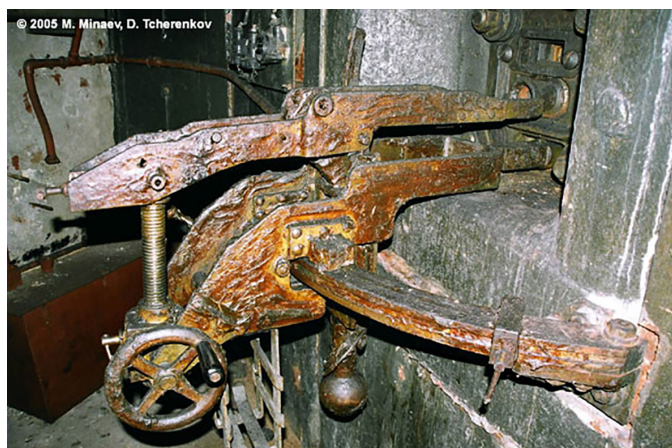
Установка НПС-1 в консервационной смазке [26].
