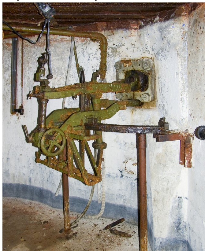
Установка НПС-3 в огневой точке Карельского укрепрайона.
