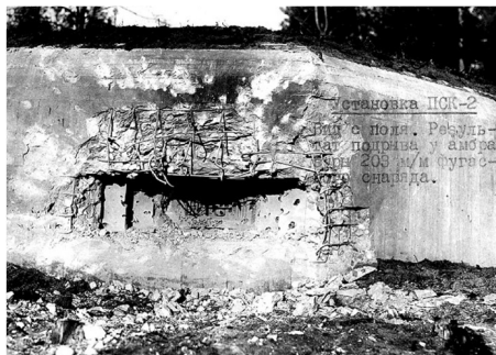
ДОТ № 213 Минского УР с ПСК-2 после испытательного подрыва у амбразуры 203-мм фугасного снаряда в 1940 году [16].
