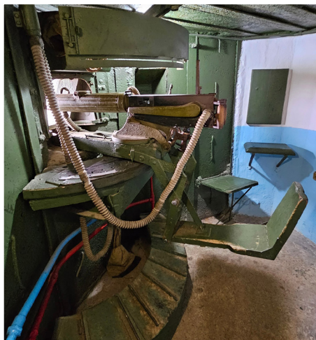
Пулеметный станок ПС-31 В.П. Горнасталева [17].
