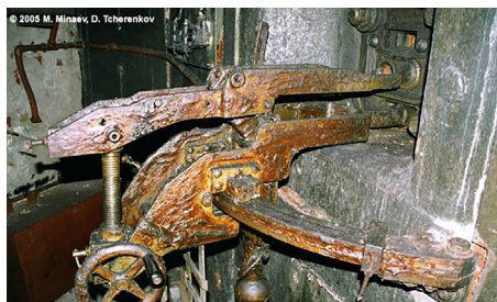
Установка НПС-1 в консервационной смазке [26].
