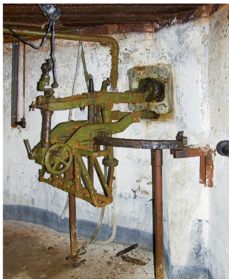
Установка НПС-3 в огневой точке Карельского укрепрайона.
