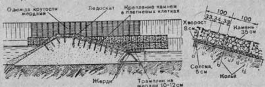
Рис. 7. Схема защиты земляной плотины от весеннего половодья камнем в клетках.
